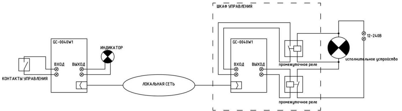
Рисунок 5.3. Схема подключения с реле
