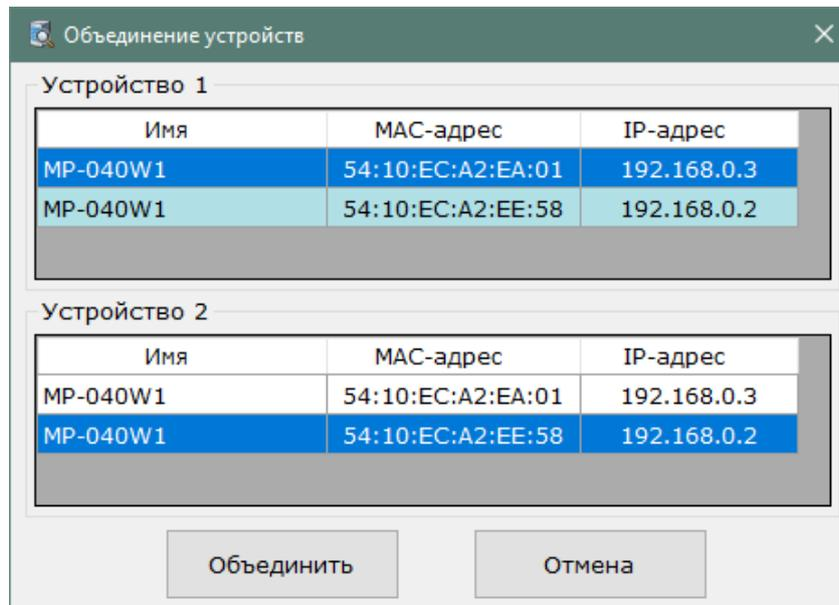
Рисунок 5.17. Окно объединения устройств
