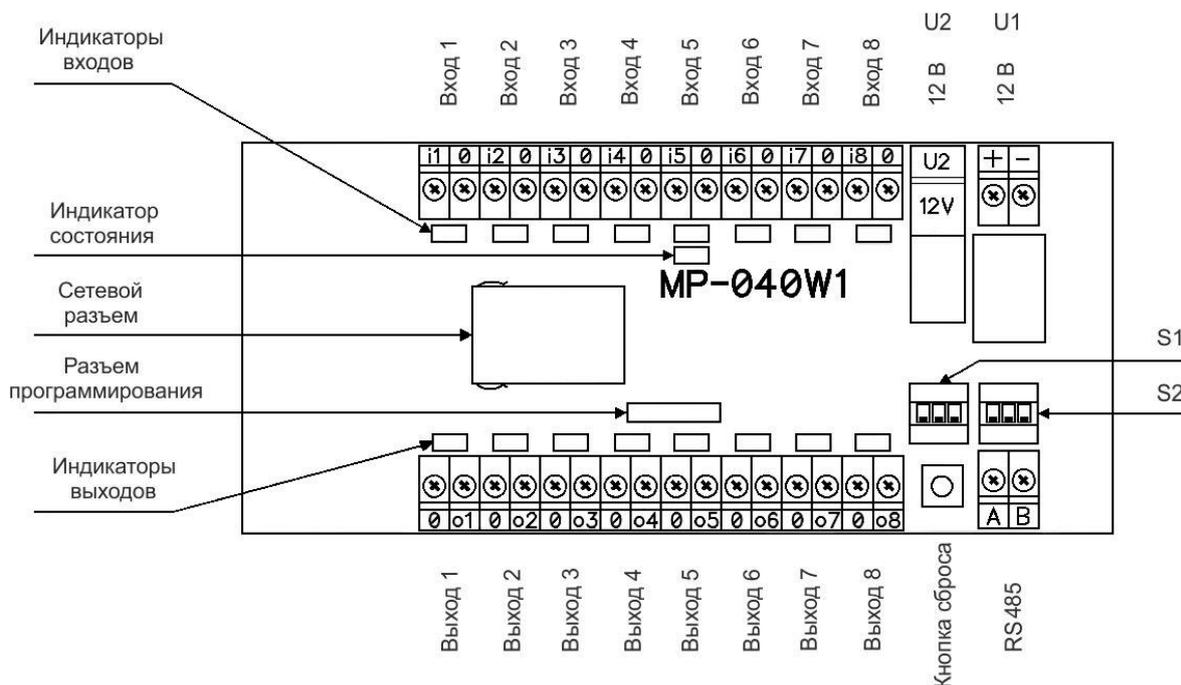
Рисунок 5.1. Внешний вид платы блока управления MP-040W1
