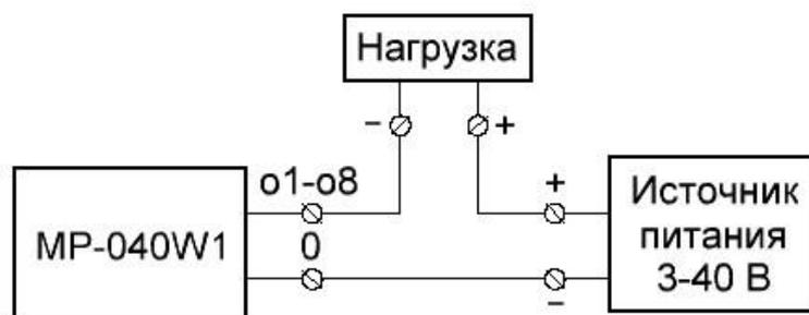
Рисунок 5.2. Схема подключения нагрузки
