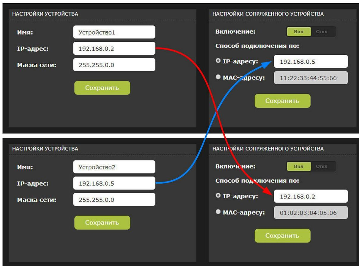
Рисунок 5.13. Пример настройки двух устройств
