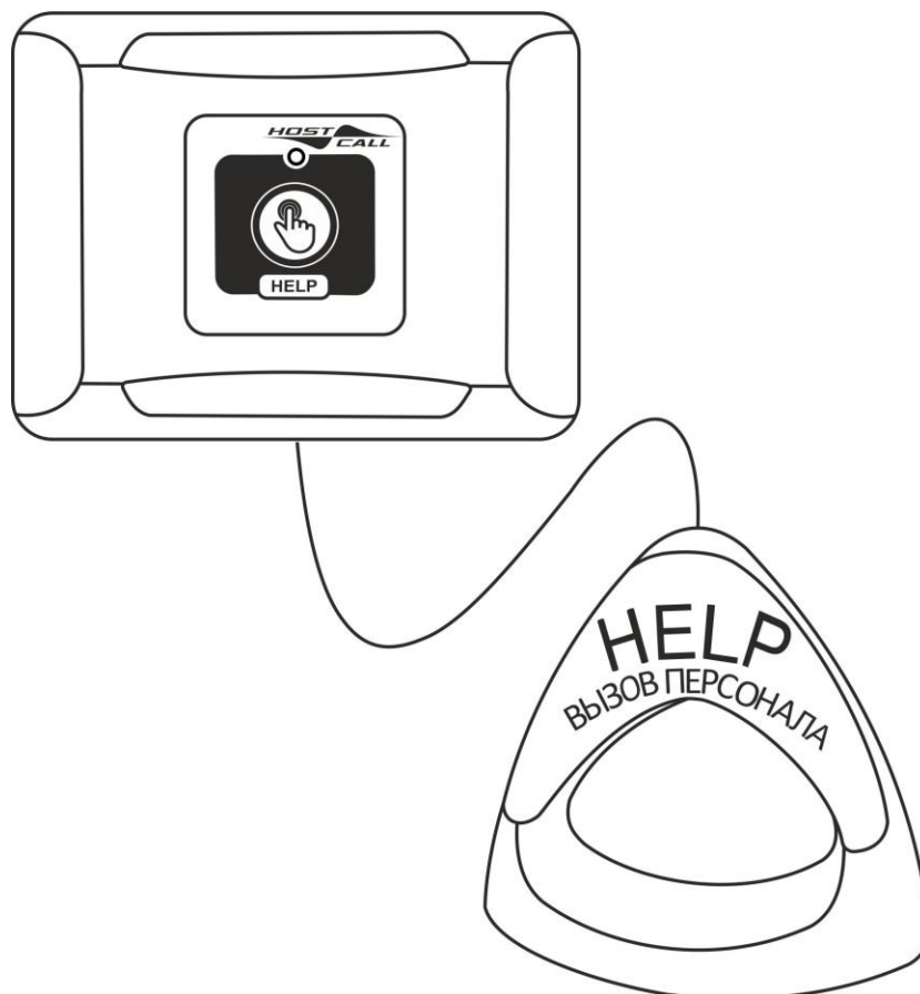
Рисунок 5.10. Влагозащищенная радиокнопка вызова со шнуром MP-413W2
