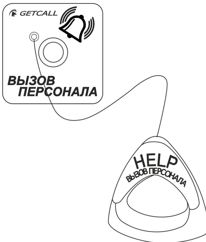
Рисунок 5.4. Влагозащищенная кнопка вызова со шнуром GC-0423B1
