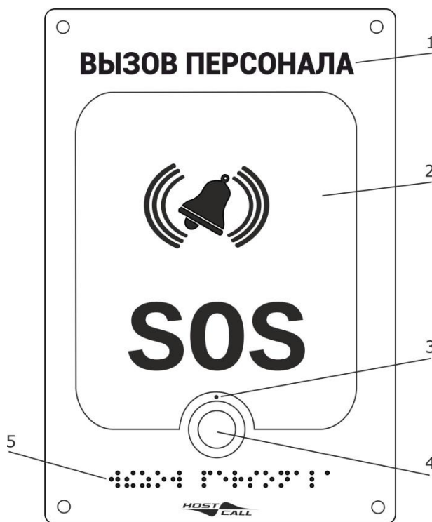
Рисунок 1. Внешний вид кнопки вызова GC-0423W6
