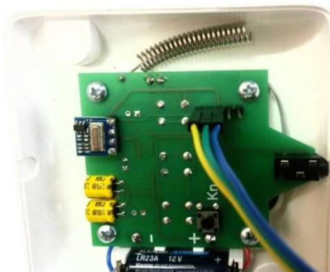
Рисунок 3. Подсоединение кабеля к радиокнопке
