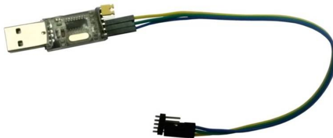
Рисунок 2. Переходник USB-UART с кабелем
